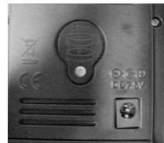
Wenn diese Batterien ersetzt werden müssen, entfernen Sie die kleine Schraube auf der Rückseite des Empfängers, wo die Batterien untergebracht sind (mittlerer Bereich des Fotos rechts oben).
