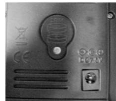
S'il faut changer les piles, retirez la petite vis au dos du récepteur où se trouve le compartiment à piles (au milieu de l'image de droite ci-dessus).
