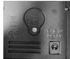
Si estas pilas necesitan cambiarse, retire el pequeño tornillo de la parte posterior del receptor que contiene las pilas (área central de la imagen derecha anterior).
