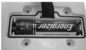
Retirez les quatre petites vis (illustrées dans l'image ci-dessus) situées sur le couvercle de l'anémomètre à l'aide d'un petit tournevis. Insérez deux piles AA (fournies par l'utilisateur) comme indiqué dans le capteur (voir image de droite ci-dessus). Remettez le couvercle de l'anémomètre en réinstallant les quatre petites vis qui le maintiendront en position.
