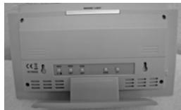
Abra el compartimiento de las pilas en la parte posterior del receptor (ubicado en el centro superior de la imagen a la derecha). Introduzca entonces seis pilas AA (proporcionadas por el usuario) con la polaridad orientada según se indica en el compartimiento de las mismas (vea la imagen de la derecha). Después de la instalación, coloque la tapa del compartimiento de las pilas en su lugar.
