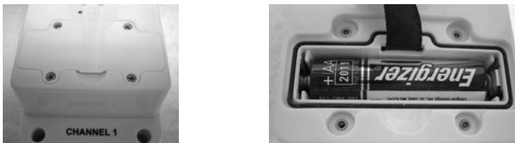
Entfernen Sie die vier kleinen Schrauben (siehe Foto oben) an der Tür des Anemometers mit einem kleinen Schraubendreher. Legen Sie zwei AA-Batterien (nicht im Lieferumfang enthalten) ein, wie im Sensor angezeigt (siehe Foto rechts oben). Legen Sie die Tür des Anemometers wieder an, indem Sie die vier kleinen Schrauben wieder eindrehen.
