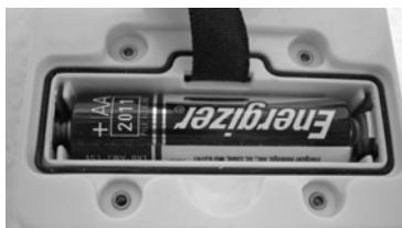
Servendosi di un piccolo cacciavite, togliere le quattro viti piccole (vedere la fotografia soprastante) dalla copertura dell'anemometro. Inserire due batterie AA (non in dotazione) nel modo indicato sul sensore stesso (vedere la foto soprastante). Rimettere a posto il coperchio posteriore dell'anemometro e rimettere le quattro viti piccole che lo tengono fisso.
