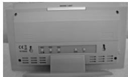
Öffnen Sie die Batteriefachür auf der Rückseite des Empfängers (oben in der Mitte des Fotos links) und legen Sie sechs AA-Batterien (nicht im Lieferumfang enthalten) ein, wie durch die Polaritätssymbole im Batteriefach angezeigt (siehe Foto rechts). Legen Sie dann die Batteriefachür wieder an.
