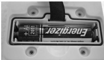
Extraiga los cuatro pequeños tornillos (que se muestran en la imagen anterior) de la tapa del anemómetro con un destornillador pequeño. Introduzca dos pilas AA (proporcionadas por el usuario) como se indica en el sensor (vea la imagen anterior). Coloque la tapa del anemómetro instalando los cuatro pequeños tornillos que la sujetan en su lugar.
